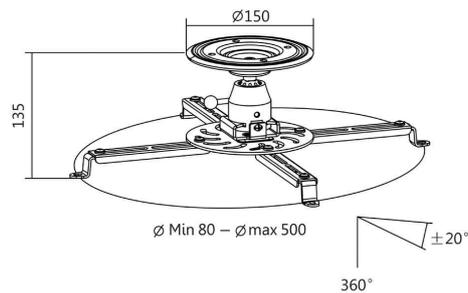
Beamer-Deckenhalterung - Abmessungen
