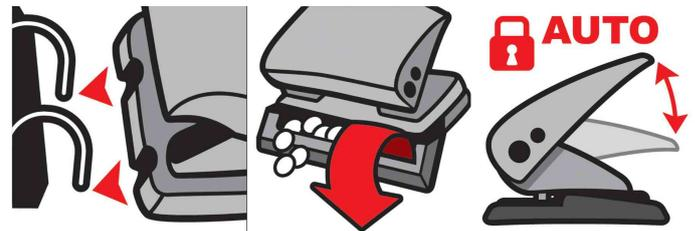
Anschlagsschiene - System zum Zentrieren - Entleerungsklappe - Oberteilverriegelung
